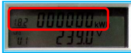
Bsp. digitaler Stromzähler Zählerstand mit OBIS 1.8.2
