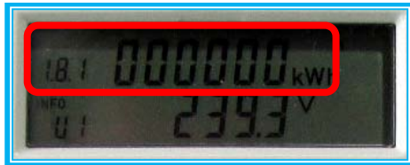
Bsp. digitaler Stromzähler Zählerstand mit OBIS 1.8.1
